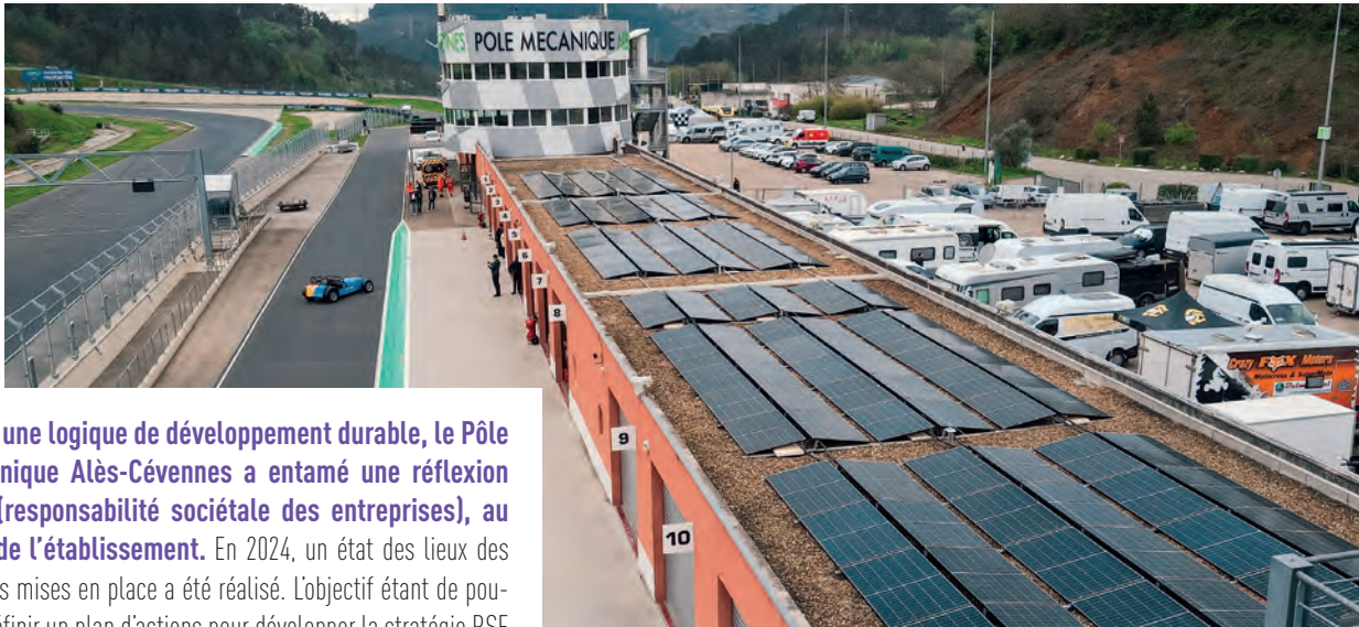
Des panneaux photovoltaïques pour un taux d'autoconsommation de 92 %.
